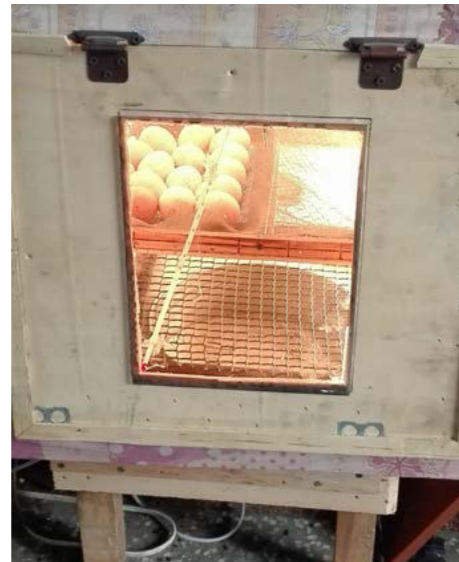
Figura 5. Incubadora artesanal de madera, anime y cartón, elaborada por Angel Díaz
